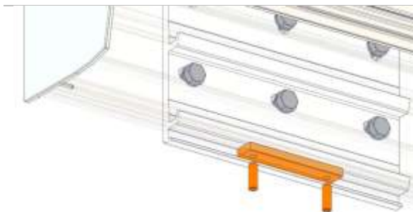
Figuur 12 - Klemstrip in het doorschuiven tot het midden van de muursteen
