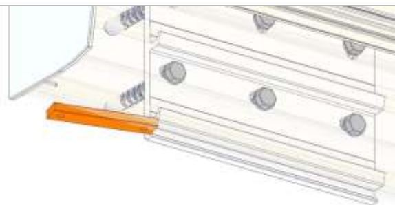
Figuur 11 - Klemstrip tussen muursteen en achterkap plaatsen.
